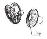
3. Sujete la grilla delantera y la trasera con el anillo de seguridad. Luego apriete el tornillo y la tuerca de bloqueo de la grilla del ventilador Es muy importante que antes de apretar las grillas delantera y trasera con el anillo de seguridad, se verifique que este se encuentre bien encastrado a lo largo de toda la circunferencia.
